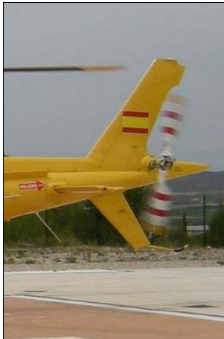
Ilustración 2: Rotor de cola (zona de extremo peligro).
