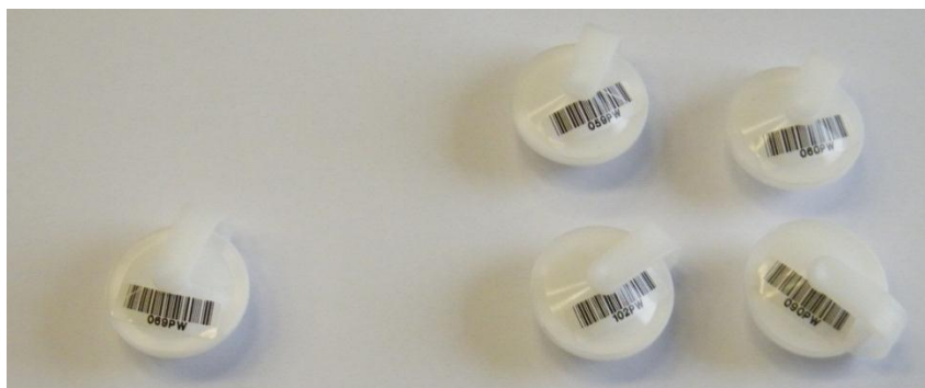
Filtro "blanco" (no usado) y filtros empleados en la medición de los puestos de trabajo
