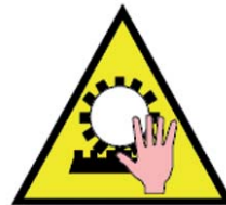
Cartel de peligro de atrapamiento
