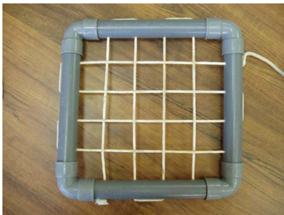
Figura 3 Estructura de PVC de 25x25cm 2 utilizada durante el seguimiento de las comunidades bentónicas para la obtención de los porcentajes de cobertura de algas e invertebrados.
