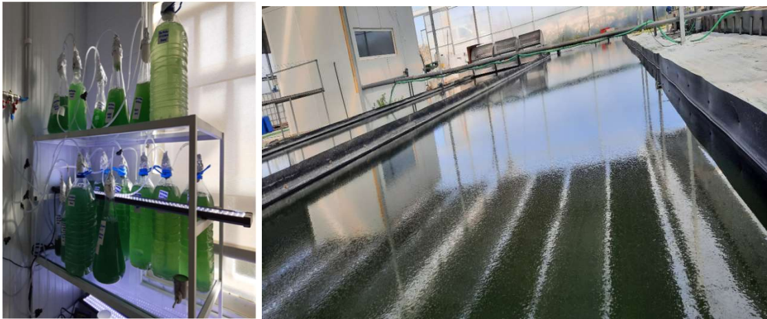
Ilustración 13: Primer y segundo escalado en el laboratorio y producción final en raceways bajo invernadero.
