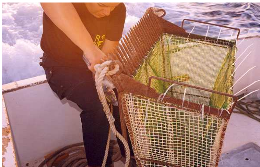
Fotografía 8: Imagen del proceso de montaje de la malla de 5 mm sobre el rastro con malla comercial de 20 mm.
