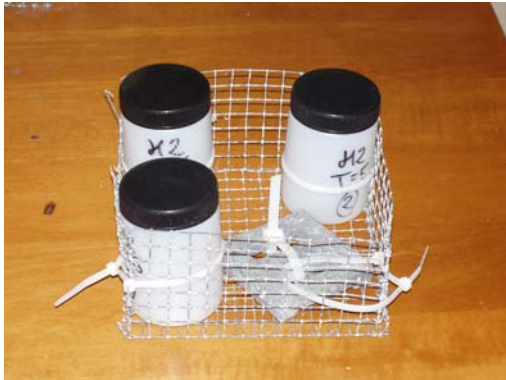
Fotografía 3-3 Estructura utilizada para la captación de sedimento
