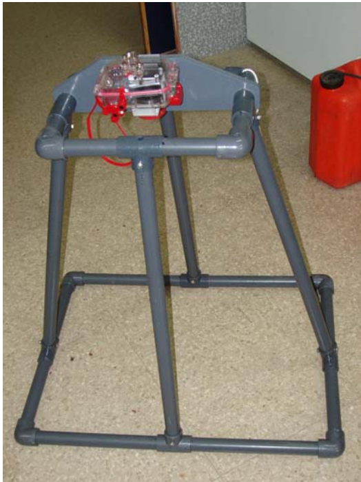
Fotografía 3-2 Estructura rígida de PVC utilizada para la toma de fotografías en el estudio de bentos
