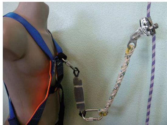
DAD sobre línea de anclaje flexible de cuerda. DAD dotado de equipo de amarre inseparable. Se instalará absorbedor de energía si lo indica el fabricante del DAD.
