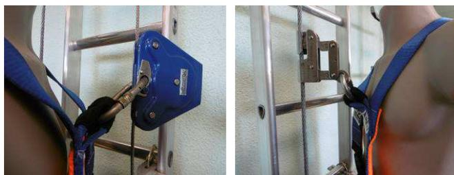
DAD sobre línea de anclaje flexible de cable instalado en una escalera
