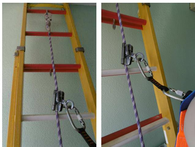
DAD sobre línea de anclaje flexible de cuerda conectada en una escalera de mano extensible. La escalera dispone de puntos de anclaje para conectar el sistema.
