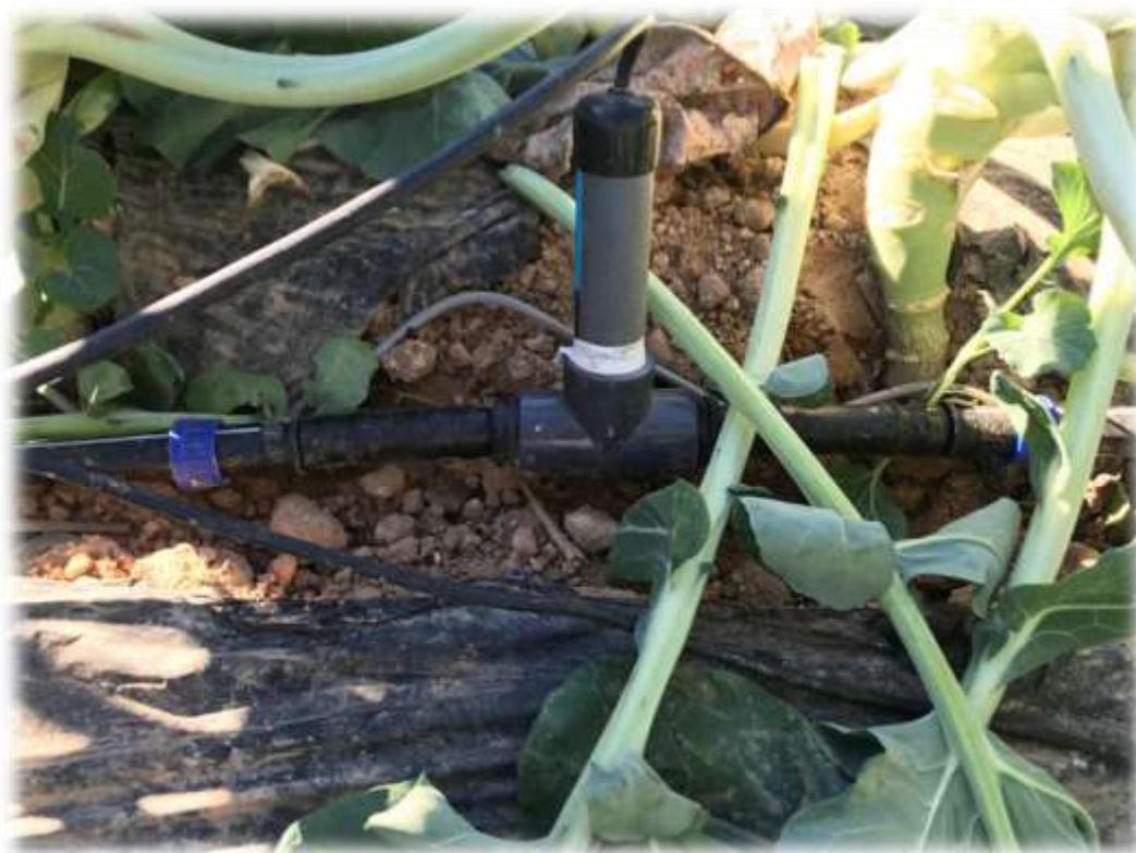
Imagen nº6 Conductímetro para medida de CE en agua de riego
