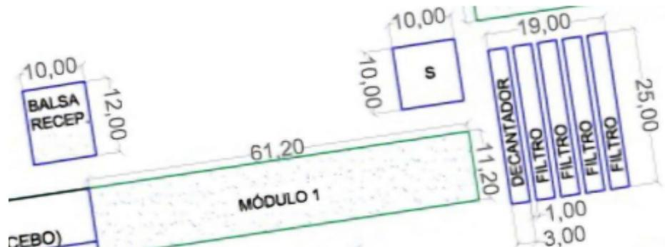
*Se prevé la realización de un depósito receptor del purín procedente de las naves, construido polietileno de 2 mm, con unas medidas de 10 x 12 x 4 metros, en el cual se recibe el purín de la granja, se homogeneiza, y se pasa por un separador de purines sólido líquido.*
