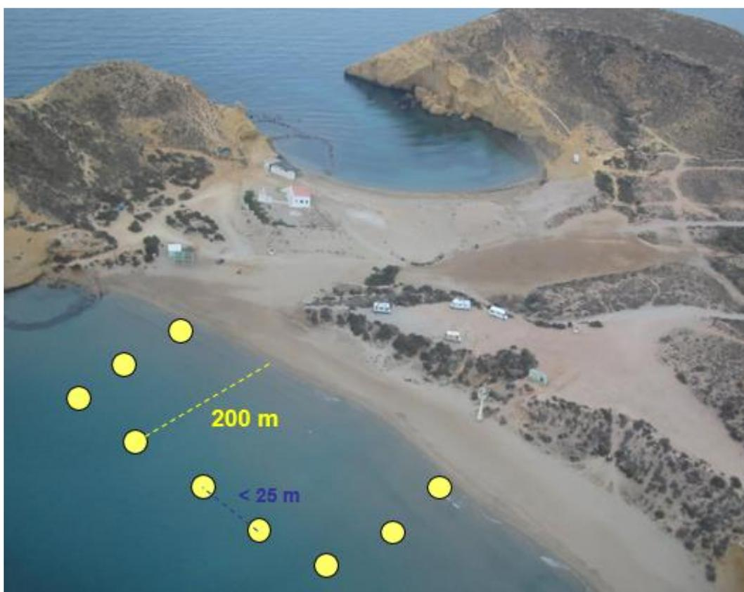
BALIZAMIENTO DE CANALES DE ACCESO Se establecerán canales de entrada o salida y de varada de embarcaciones en aquellas playas que lo permitan Son de anchura variable entre 25 y 50 m.. La entrada a estos canales transversales de paso se
