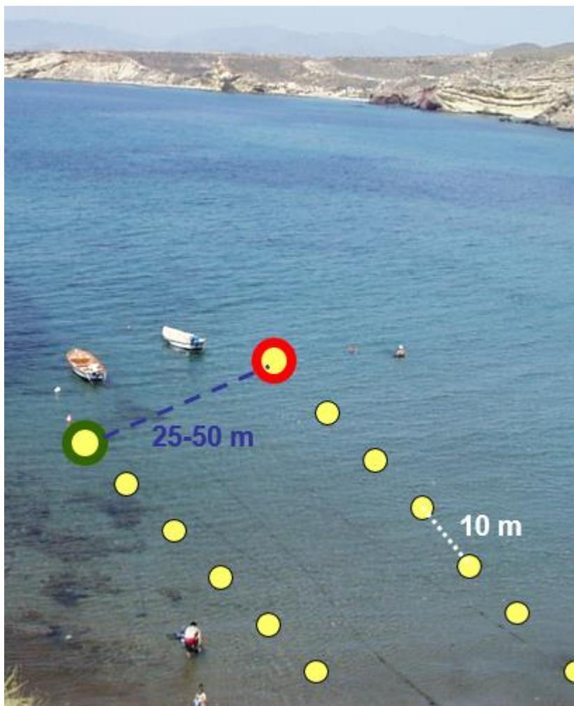
BALIZAMIENTO DE ZONAS PROHIBIDAS DE BAÑO Las zonas cerradas al baño de una playa se señalarán mediante boyas amarillas de 40 cm de diámetro, unidas por cabos o cables flotantes y boyarines de color rojo de 20 cm de diámetro, estas zonas deberán contar con carteles de prohibido el baño.
