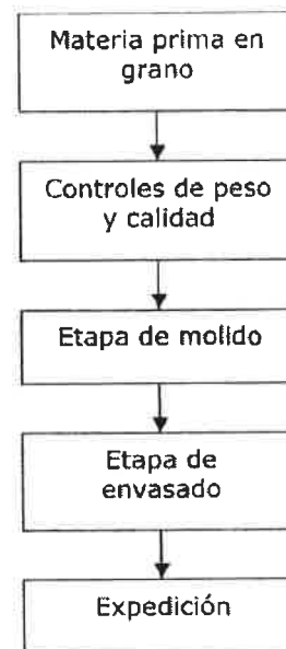
Diagrama de flujo específico de elaboración de diversas especias
