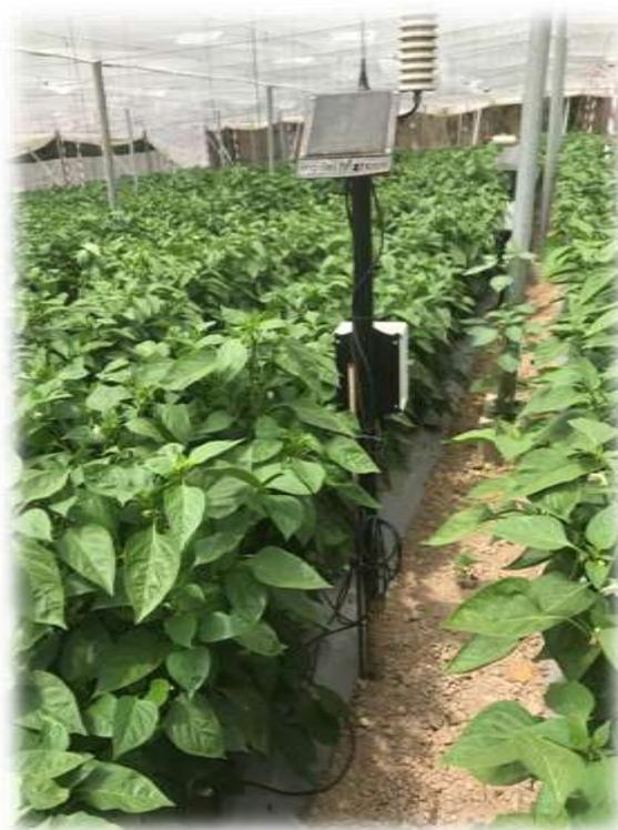
Equipo de tensiómetros de humedad de suelo
