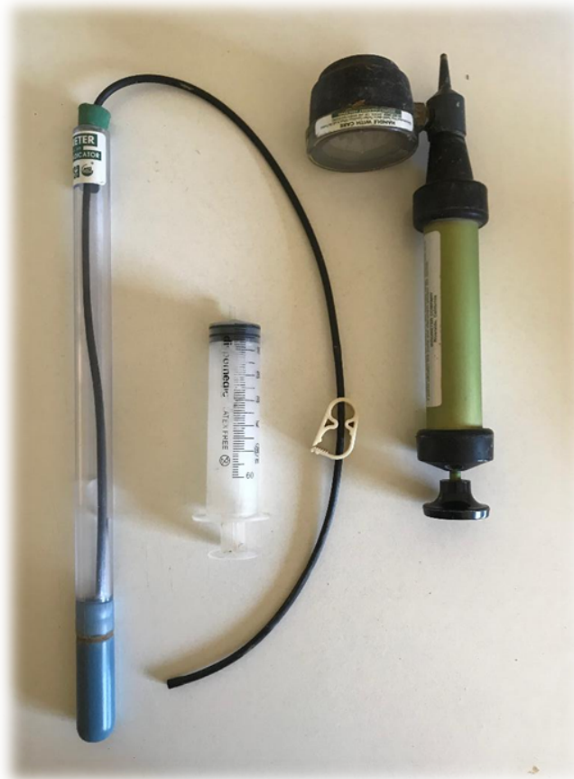
Imagen nº3 Sonda de succión y válvula para hacer el vacío
