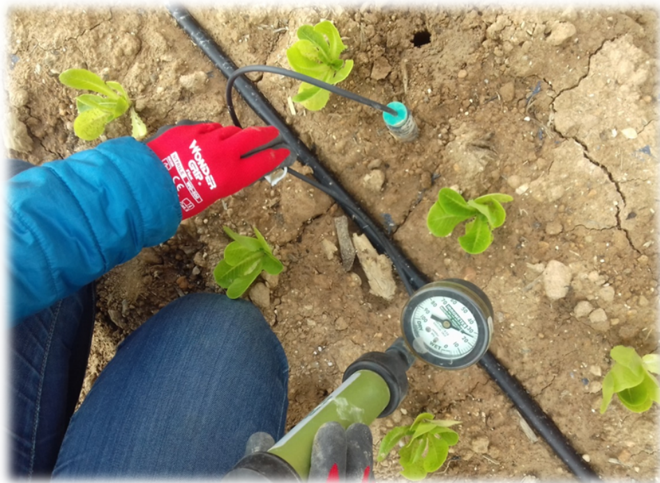
Imagen nº4 Obtención vacío en la sonda de succión
