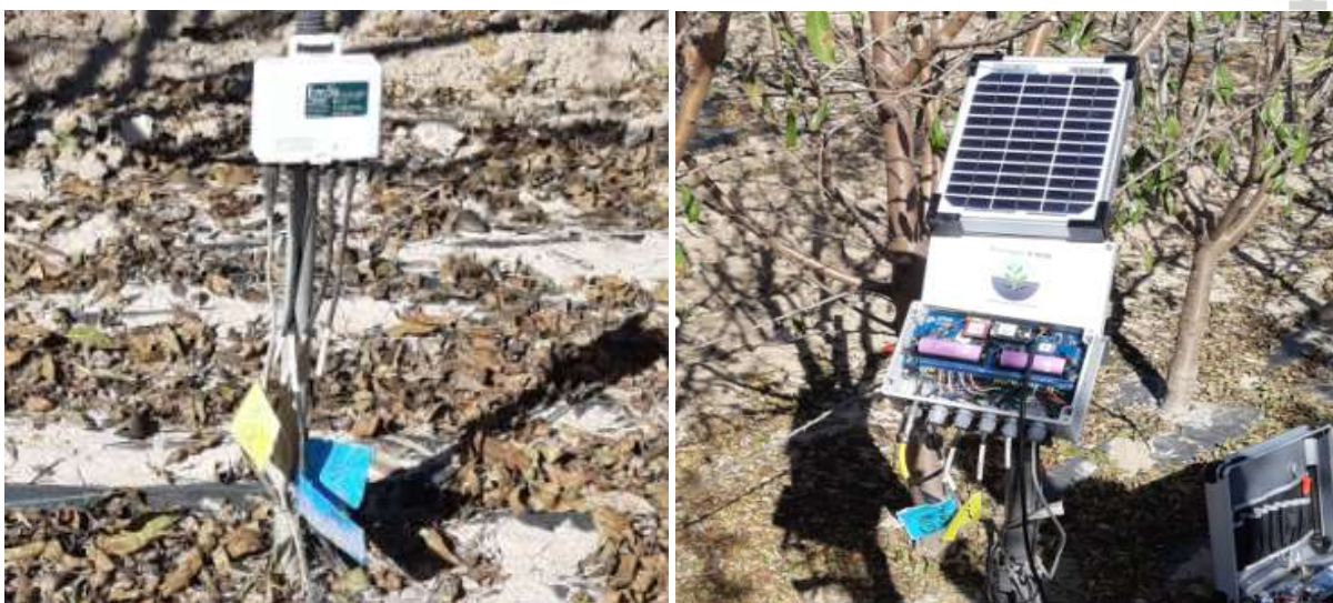
Fotos nº 4 y 5. Sensores colocados en la parcela y datalogger alimentado por placa solar.
