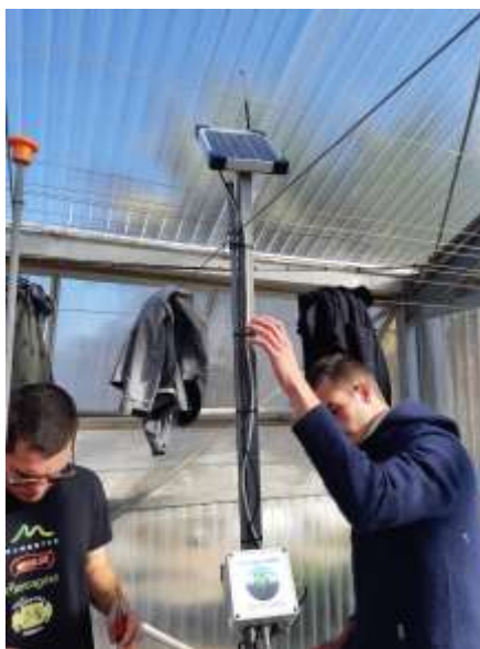
Foto nº 8. Colocación datalogger y transmisor de datos en invernadero hidropónico (08/11/2019).
