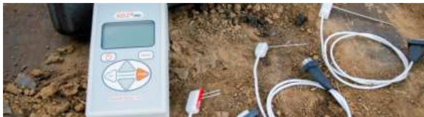
Foto nº 9. Dispositivo Hobo y sensores para obtención de datos de humedad en suelo.
