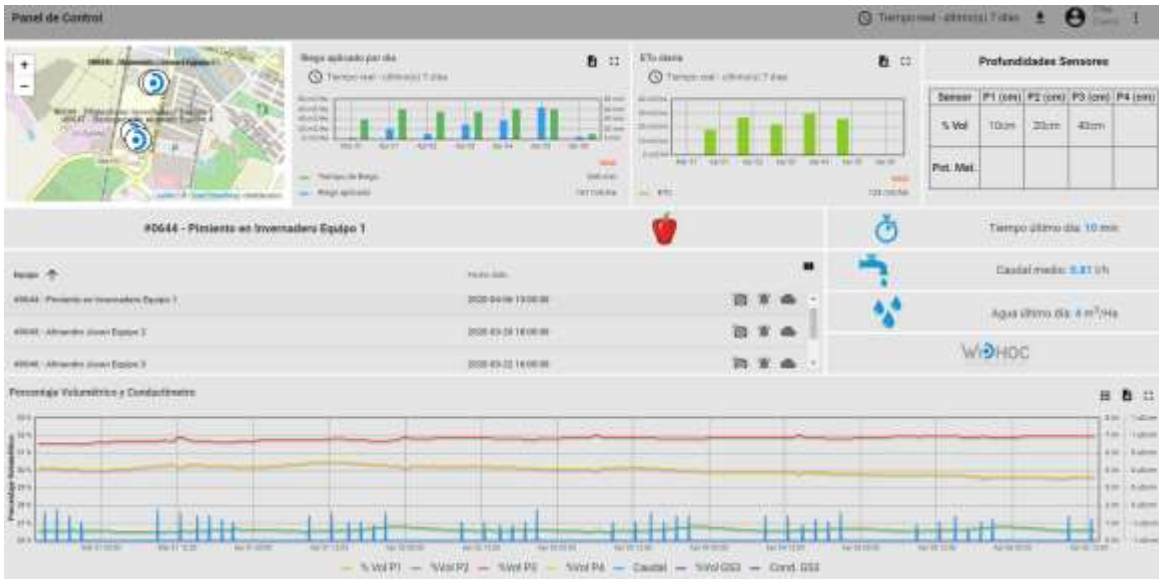
Gráfica nº 5 . Panel de control del sistema de medición de humedad en el suelo.
