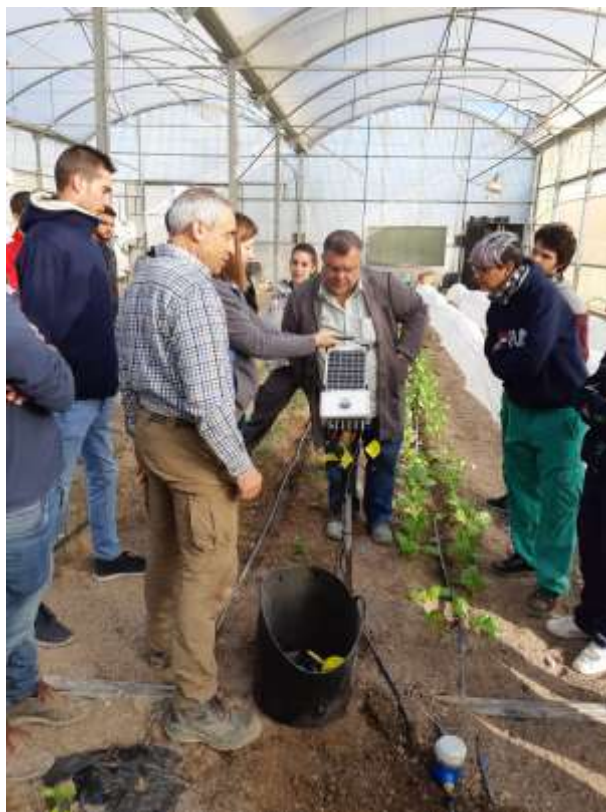
Foto nº 15. Sensores y caudalímetro colocados en la parcela y datalogger alimentado por placa solar (08/11/2019).
