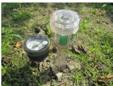
Foto nº 10. Tensiómetro para el control de la humedad del suelo.
