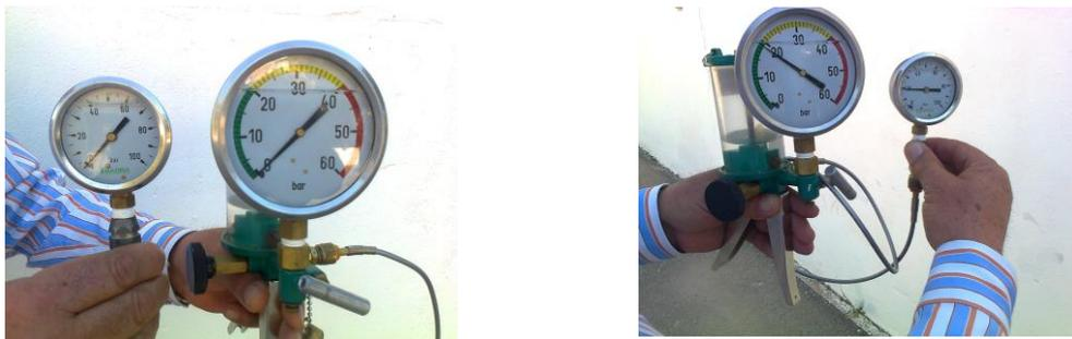
Con la ayuda de un comprobador de presión para manómetros y teflón, se realiza la comprobación del manómetro de la máquina, con la participación de los asistentes a la práctica.
