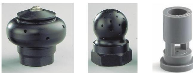
Esta boquilla se utiliza para agitar el líquido en el interior del depósito. El efecto Venturi de la boquilla aumenta varias veces la agitación respecto al líquido que pasa por el orificio calibrado de la boquilla. Recomendada para la agitación continuada de mezclas de productos fitosanitarios.
