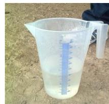
Comprobamos que el agua depositada en la probeta se corresponde con los 0,875 l/minuto, teniendo en cuenta que puede haber un margen de error del 5% máximo.
