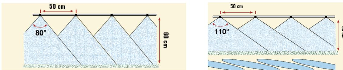
La altura de la barra depende del tipo de boquilla, por lo que debe verse en el catálogo del fabricante. Lo habitual son las boquillas que trabajan a 50 cm de altura.
