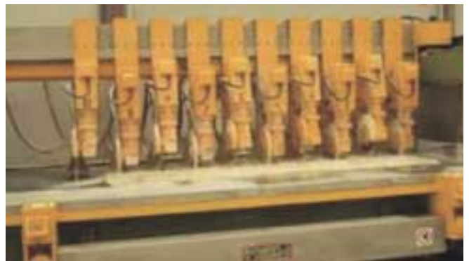
Corte de baldosas con multidisco transversal
