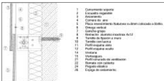
Junta horizontal sección vertical
