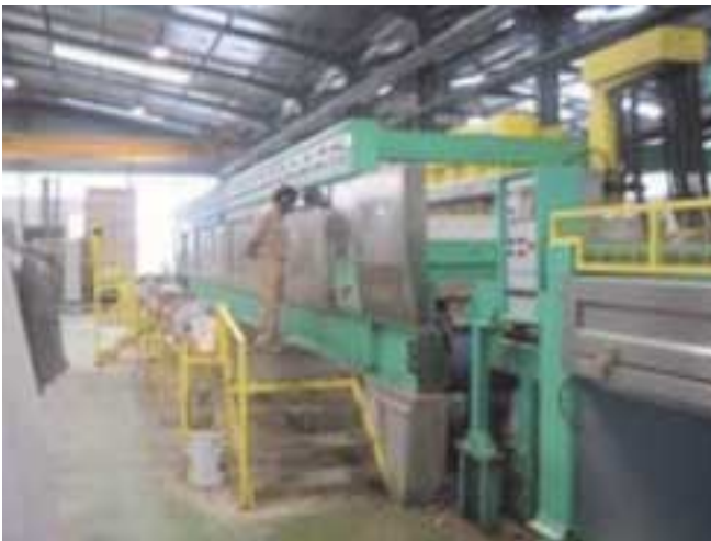
Proceso de pulido y abricantado.
