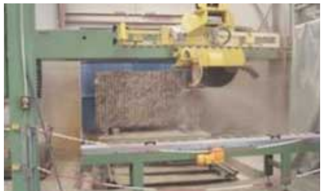
Otro sistema de corte. Cortadora puente con disco horizontal y vertical (Cortabloques o tallabloques)
