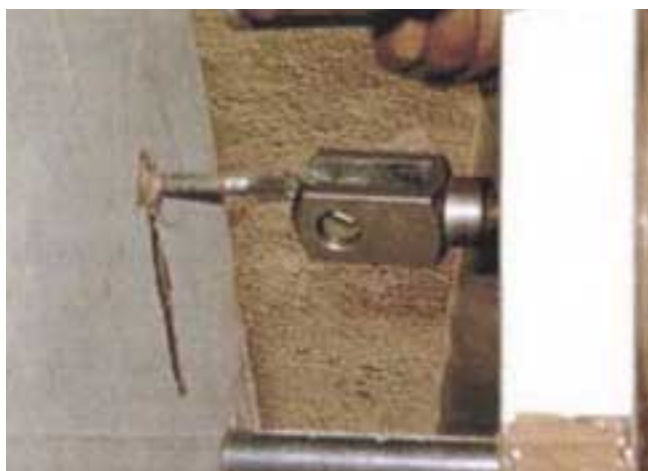
Perno horizontal. Aspecto después del ensayo
