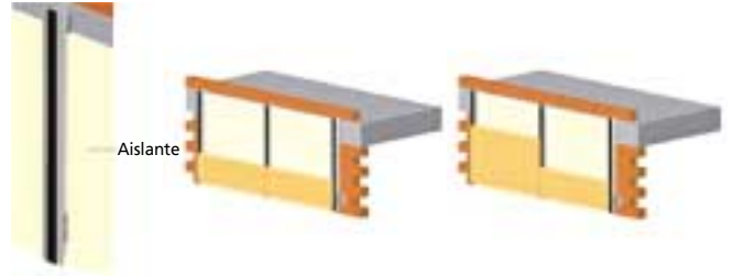
Secuencia de montaje de las piezas colocadas horizontalmente
