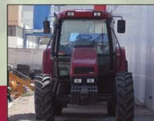
Cabina de seguridad
