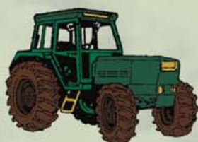
Cabina de seguridad
