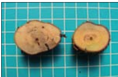
Daños de hongos de madera.
