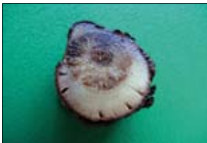
Daños de hongos de madera.
