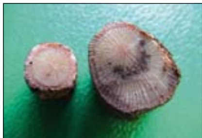
Daños de hongos de madera.
