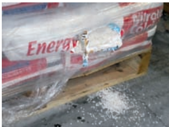
Saco de nitrato de calcio con una rotura que provoca el derrame de su contenido.
