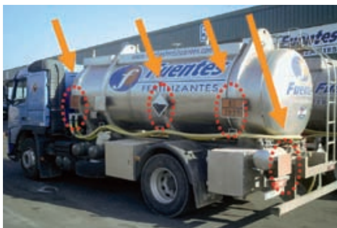
Señalización en vehículos con mercancías peligrosas en cisterna.
