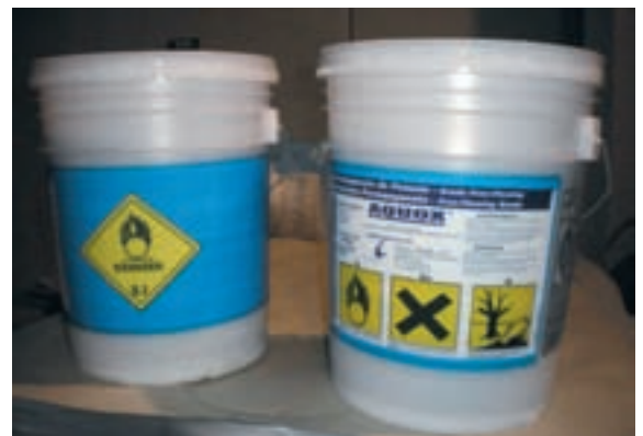
Envases de permanganato potásico con las pertinentes señalizaciones de peligro.
