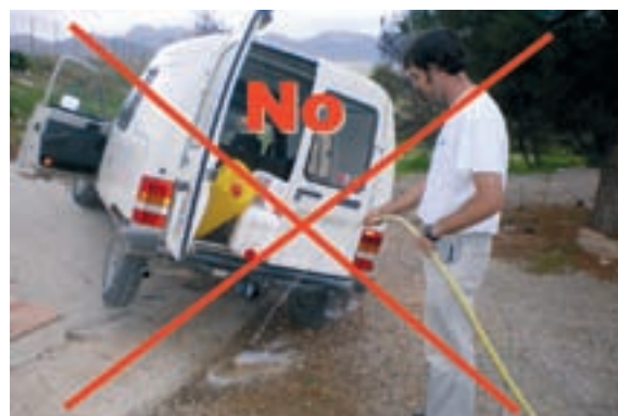
No se debe aplicar de forma incontrolada agua sobre el vertido.
