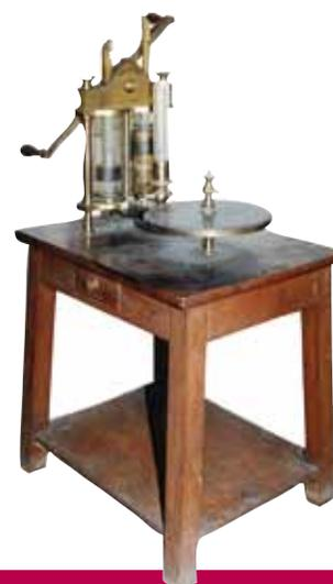
engrana en sus cremalleras y movida por una manivela de dos brazos. El émbolo que sube extrae el aire del recipiente mediante una válvula, situada en la parte inferior del cilindro, que abre hacia arriba, al bajar dicha válvula cierra impidiendo la entrada de aire. El émbolo que baja lo hace abriendo una válvula situada en el propio émbolo que también abre hacia arriba, cuando el émbolo sube dicha válvula permanece cerrada.
