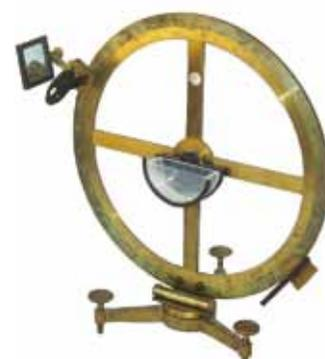
Con este aparato montado sobre un trípode con tornillos es posible enviar un rayo de luz que atraviesa un recipiente semicilíndrico lleno de agua. Dos alidadas y una escala graduada nos permiten medir los ángulos de incidencia, reflexión y refracción.
