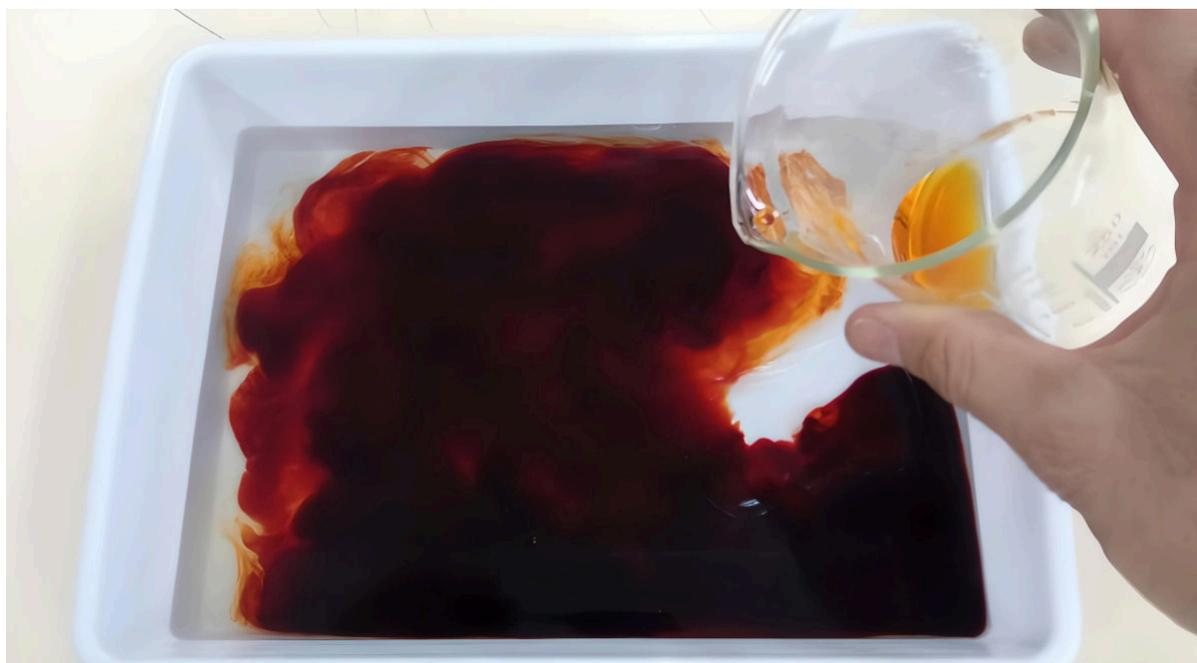
**Figura 22.** Reacción química llevada a cabo tras el vertido del catión férrico presente en el vaso de precipitados y el anión sulfocianuro disuelto en el agua de la bandeja. El color rojo sangre llama muchísimo la atención de alumnos. Fuente: Elaboración propia.
