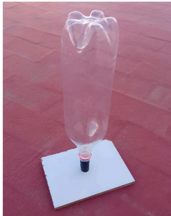
**Figura 7.** Detalle de la lanzadera del cohete de dióxido de carbono a partir de la reacción entre el bicarbonato de sodio y el vinagre.
