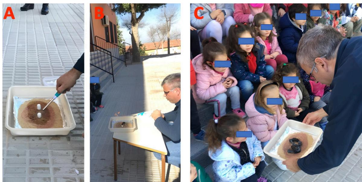
**Figura 10.** (A) Disposición de las pastillas de azúcar-bicarbonato sobre arena de playa humedecida con etanol. (B) Prendido de fuego y desarrollo de la experiencia. (C) Resultado final: "la cacotilla algezareña" o masa pulverulenta de carbón. Fuente: Elaboración propia.
