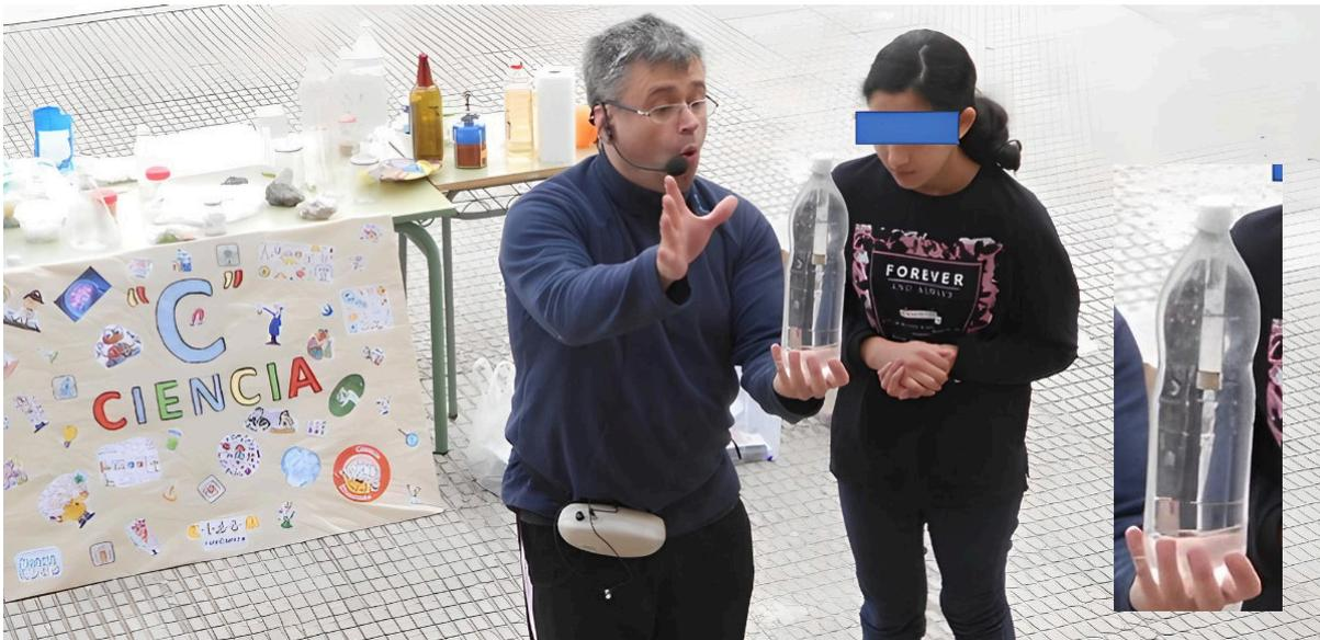
**Figura 1.** Enseñanza teatral del fundamento del "Diablo de Descartes" o Ludión. Denótese en el detalle los materiales simples de los que se constituye: botella de refresco, agua, tubo de ensayo y tapón de corcho provisto de un agujero central (que permita la entrada y salida de agua a su través). Fuente: Fotografía del profesorado del CBM Francisco Cobacho.
