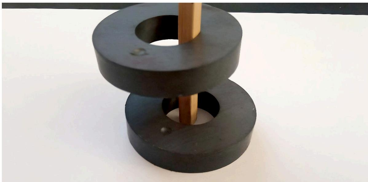
**Figura 20.** Comprobación de la polaridad de dos imanes. Tanto es el "desprecio de uno hacia el otro", repulsión, que son capaces de levitar (elevarse sin tocar el suelo). El magnetismo es magnífico y puede dar mucho juego. Fuente: Elaboración propia.
