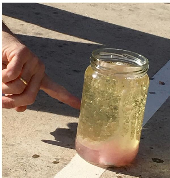
**Figura 43.** Aspecto de la "lámpara de lava". Migración de las esferas de dióxido de carbono que, por densidad, suben a la superficie y escapan a la atmósfera. Fuente: Elaboración propia.
