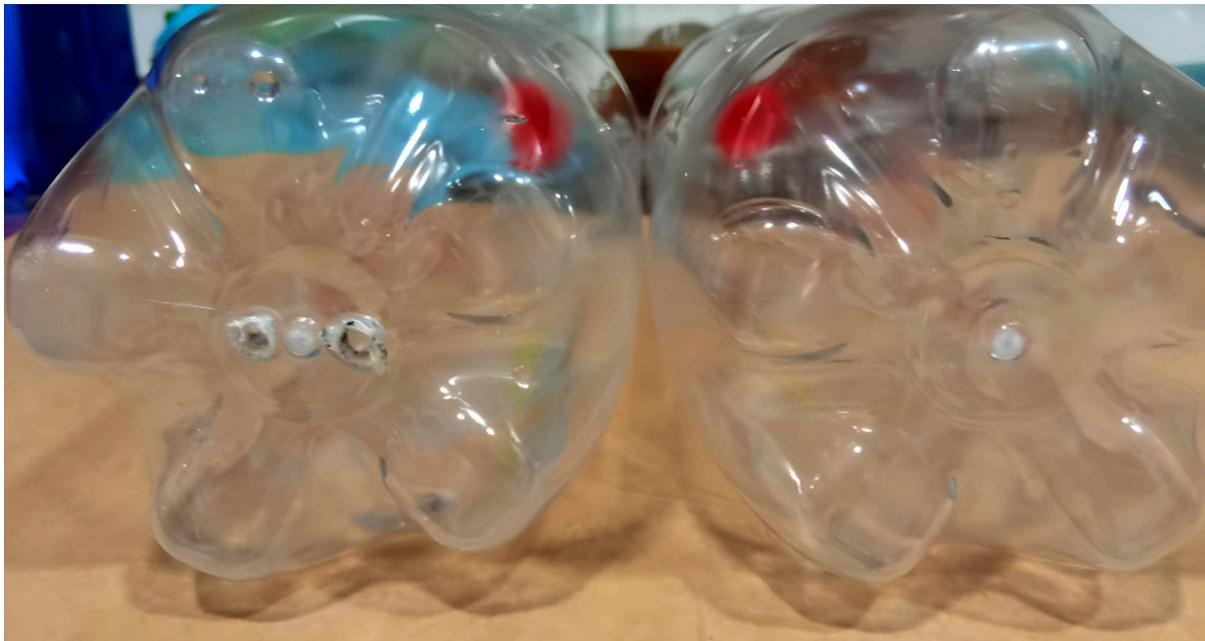
**Figura 26.** Aspecto del fondo de las botellas de refresco. La de la izquierda porta dos agujeros pasantes para proceder al vaciado del aire del interior cuando se hinche el globo en su interior. Fuente: Elaboración propia.
