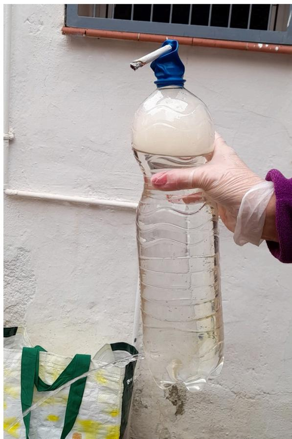
**Figura 45.** "Botella fumadora". La salida de agua a través de un agujero perforante en la botella genera una presión negativa en el interior del recipiente, compensada con la entrada de aire desde el exterior a través del cigarrillo, prendiendo a este último. Denótese la coloración del humo que se va depositando en el interior de la botella. Fuente: Elaboración propia. (Semana de la Salud en el CEA Alcantarilla. Curso 2021-2022).
