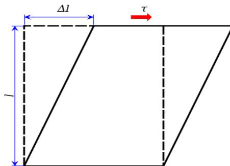
Así que una torre hecha de rectángulos (o cualquier polígono que no sea un triángulo) se derrumbaría en cuanto una esquina se aflojara un poquito...
