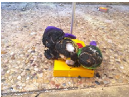
Figura 27. Estado final de la muestra 2 para el ensayo de inflamabilidad. Fuente: elaboración propia.
