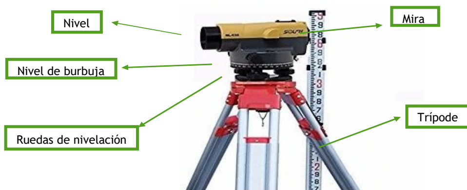
Ilustración 27: Las partes de un nivel. Fuente: elaboración propia.
