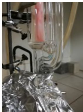
Figura 61. Detalle del filtro para soxhlet, que contiene la muestra en su interior.
