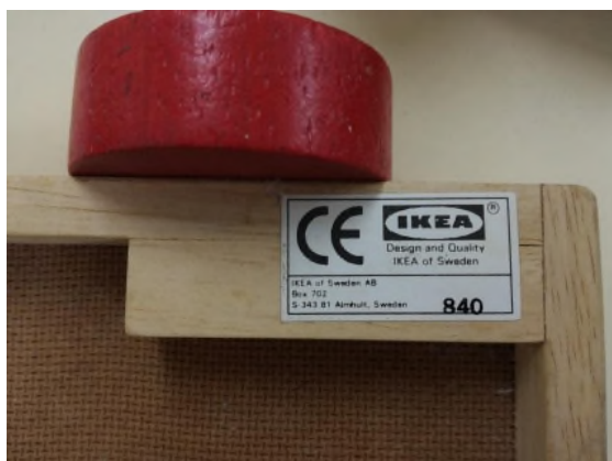
Figura 32. Detalle y etiqueta de la primera muestra del ensayo. Podemos observar que el etiquetado CE corresponde a China Exported. La segunda muestra no contiene etiqueta.
