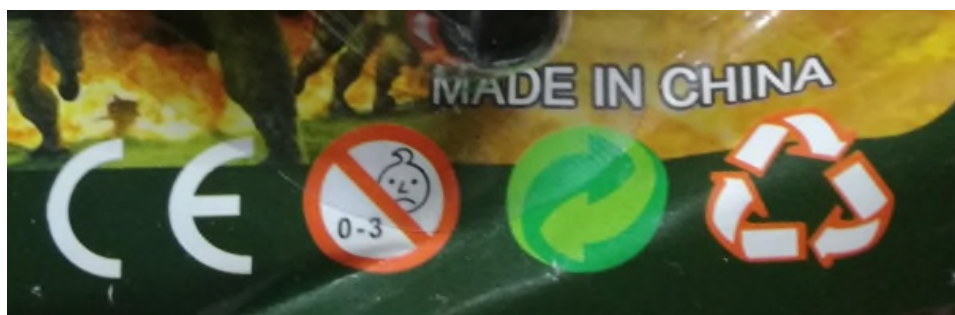
Figura 57. Etiqueta correspondiente a la muestra utilizada en el ensayo. Podemos observar el marcado CE correspondiente a Conformidad Europea y, junto a él, el indicador de uso no recomendado para menores de tres años.
