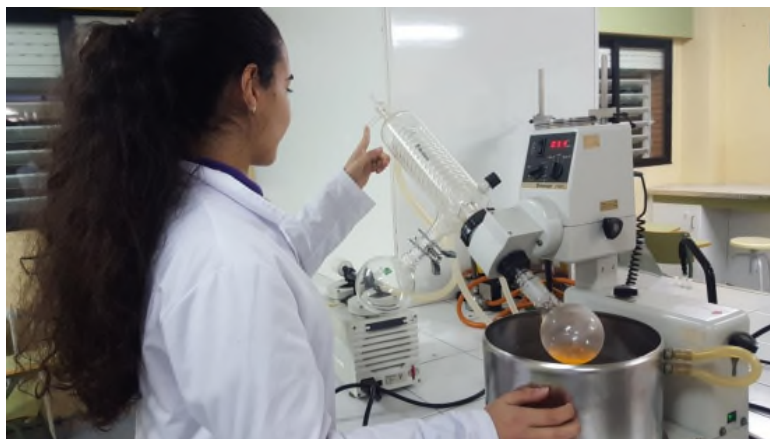
Figura 62. Uso del rotavapor para evaporar el dietileter que estaba actuando como disolvente.
