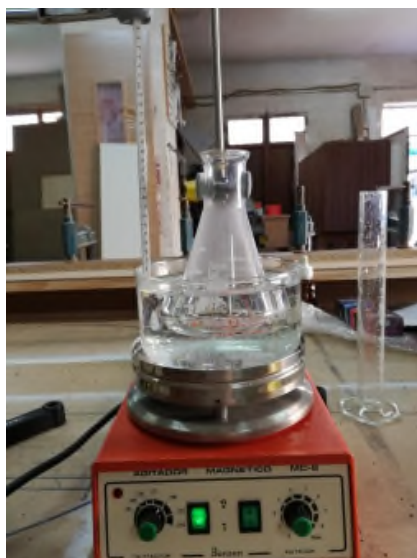
Figura 39. Montaje experimental para la digestión de la muestra. Una vez acoplado, se tapa con papel de aluminio para protegerlo de la luz.
