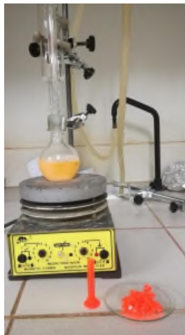
Figura 60. Montaje experimental para hervir a reflujo la muestra. El matraz se coloca sobre la placa calefactora, que incluye agitación magnética, y se le acoplan el soxhlet y el tubo refrigerante.
