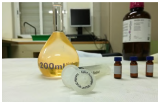
Figura 65. Materiales utilizados para la filtración de la disolución de la muestra. En el centro, la jeringa y el filtro (0,45 µm); a la derecha, los viales de 2 mL.
