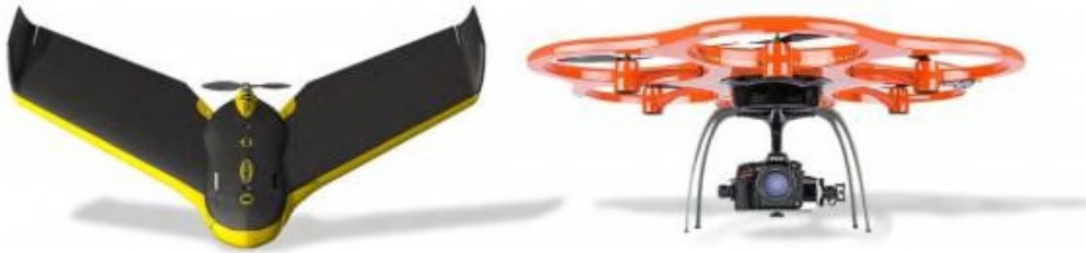
Ilustración 39: Sistemas UAV para fotogrametría de acuerdo al tipo de vuelo. (Izq) Ala fija, (Der) ala rotatoria.
