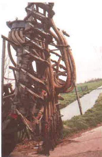
**Detalle del cultivador acoplado a la cuba de purines, donde se aprecia la salida para los purines**
