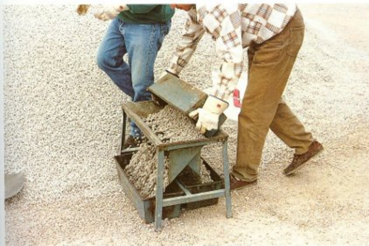
Detalle de toma de muestras con cuarteador de dos pulgadas
