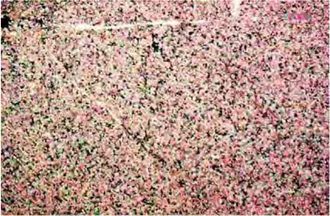
Biomicrita recristalizada con abundantes fisuras rellenas de calcita tardía y pequeñas cavidades de disolución. Polarizadores cruzados.
