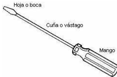
Fig. 11: Partes de un destornillador
