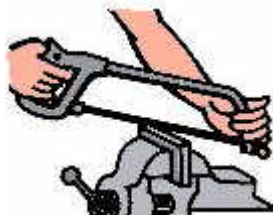
Fig. 13: Pieza fijada firmemente antes de serrar
