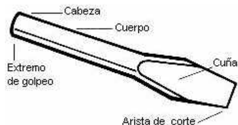
Fig. 5: Partes de un cincel
