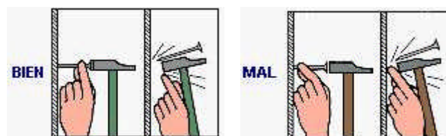
Fig. 8: Forma de sujetar un clavo antes de clavarlo
