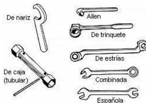
Fig. 3: Tipos de llaves de boca fija
