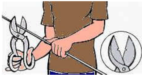
Fig. 15 Utilización incorrecta de tijeras con hojas melladas
