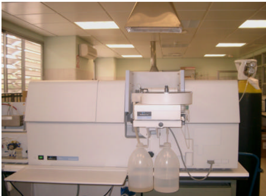
Figura IV.1 Espectrómetro de absorción atómica con atomización electrotérmica
