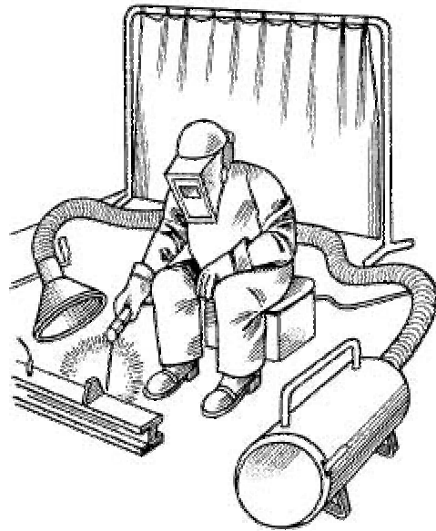
Figura I.5 Prácticas correctas de trabajo en la soldadura por arco eléctrico.
