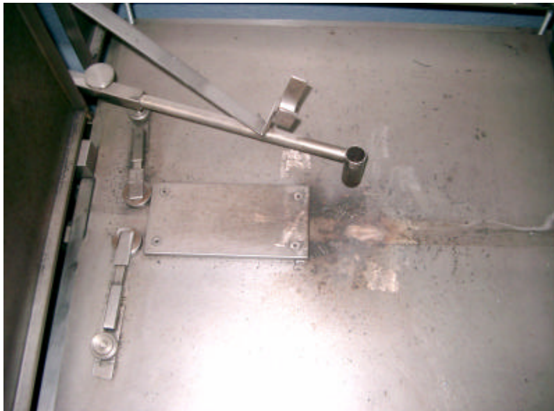
Figura IV.11 Disposición en planta de la mesa de soldadura preparada para una operación automática.
