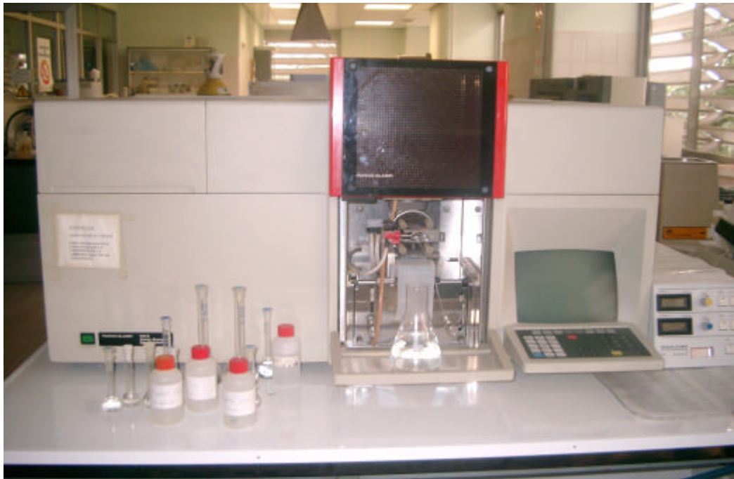
Figura IV.5 Espectrómetro de absorción atómica con llama PE-1100B.
