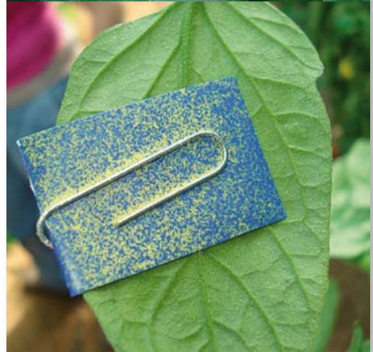
Fotos 167 y 168. Las pruebas con papel hidrosensible permiten conocer y optimizar la calidad con las que se realizan las aplicaciones
