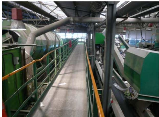
Plataforma de paso junto a un trommel
