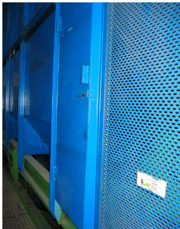
Resguardo móvil de un trommel cerrado mediante un pasador
