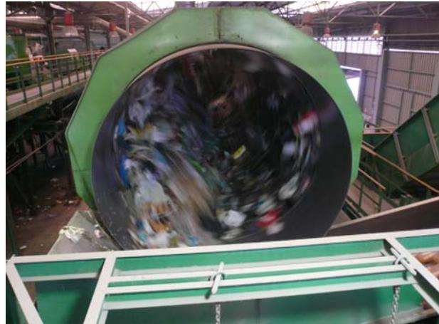
Vista de un trommel en funcionamiento
