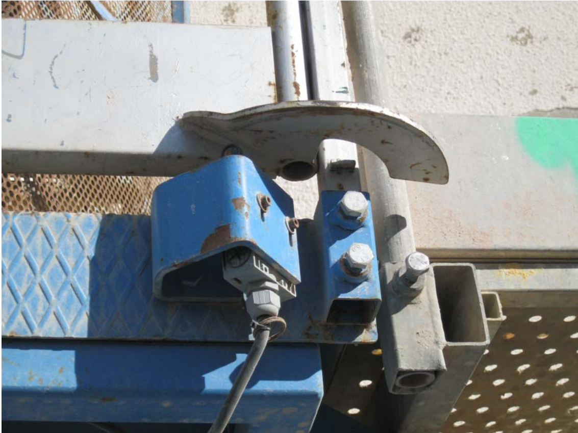
Imagen 10. Dispositivo de enclavamiento de la puerta formado por leva y final de carrera.
