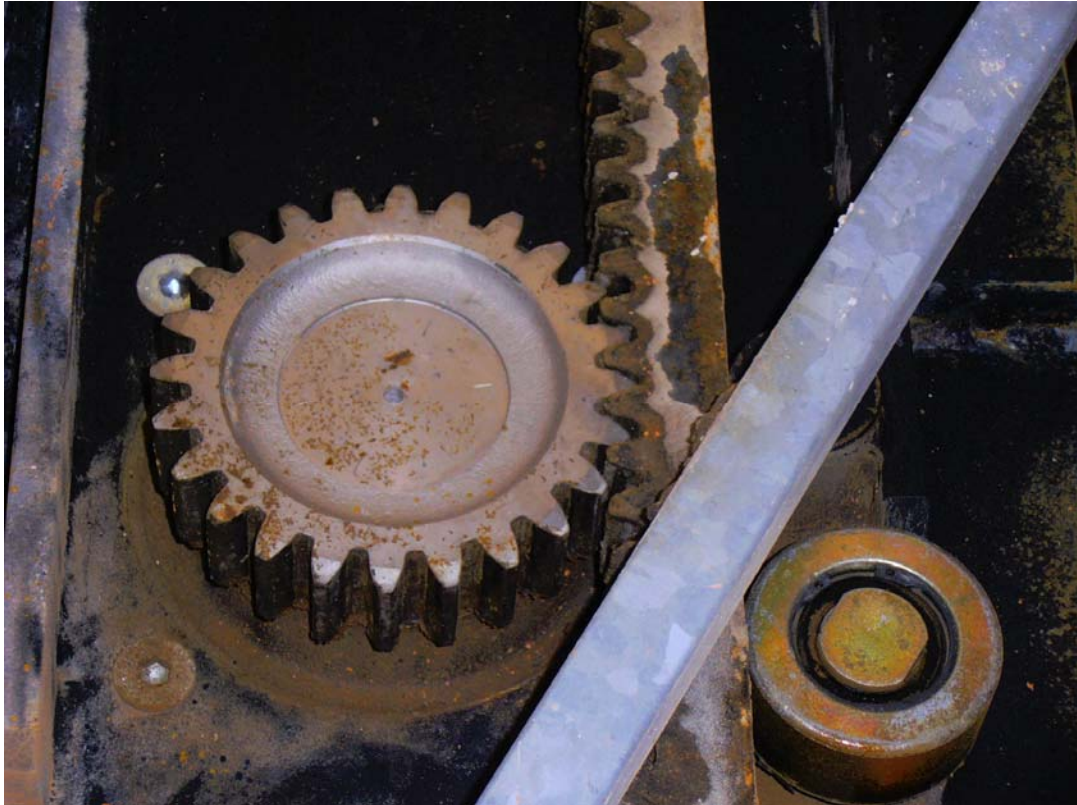
Imagen 1. Mecanismo de elevación de piñón y cremallera.
