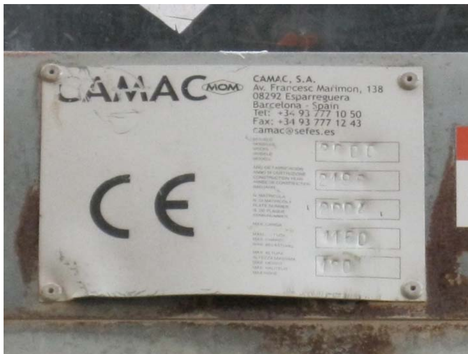
Imagen 3. Placa identificativa con datos sobre la marca, modelo, nº de serie, año de fabricación, carga máxima y altura máxima.
