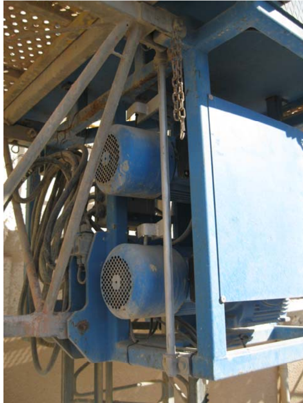
Imagen 16. Dispositivo de descenso de emergencia.
