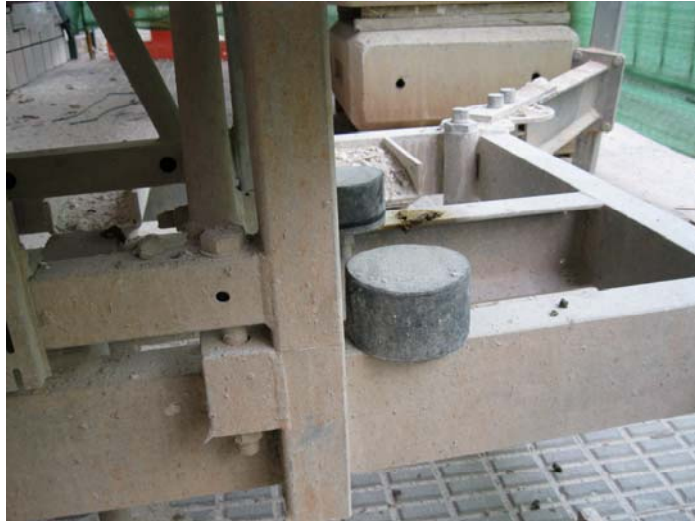
Imagen 14. Topes amortiguadores para recorrido descendente.
