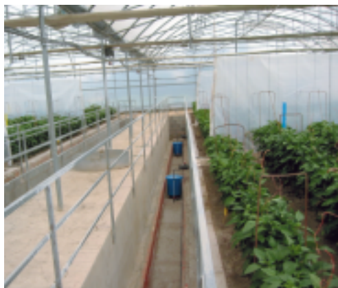
Lisímetro de drenaje.
