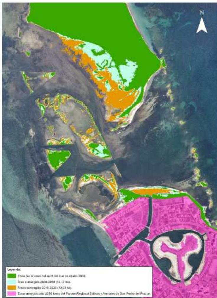
Aplicación de una subida del nivel del mar de 0,5 cm/año a la cartografía topográfica de detalle obtenida a partir del PROYECTO NATMUR-08, promovido por el departamento de medio ambiente de la Administración Regional, concretamente el Modelo Digital del Terreno 4x4 m, como consecuencia del procesamiento de los datos del levantamiento LIDAR. Fuente: Servicio de Fomento del Medio Ambiente y Cambio Climático.
