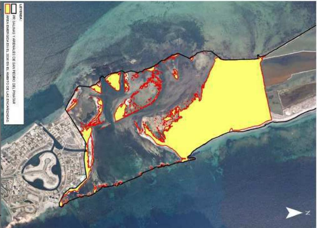
Aplicación de una subida del nivel del mar de 0,5 metros a la cartografía topográfica de detalle obtenida a partir del PROYECTO MATMUR-08, promovido por el departamento de medio ambiente de la Administración Regional, concretamente el Modelo Digital del Terreno 4x4 m, como consecuencia del procesamiento de los datos del levantamiento LIDAR. Fuente: Servicio de Fomento del Medio Ambiente y Cambio Climático.
