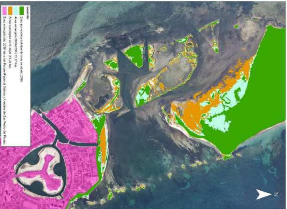
Aplicación de una subida del nivel del mar de 0,5 cm/año a la cartografía topográfica de detalle obtenida a partir del PROYECTO NATUR-08, promovido por el departamento de medio ambiente de la Administración Regional, concretamente el Modelo Digital del Terreno 4x4 m, como consecuencia del procesamiento de los datos del levantamiento LIDAR. Fuente: Servicio de Fomento del Medio Ambiente y Cambio Climático.
