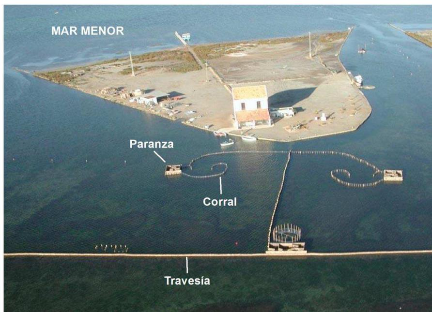
Vista de la encañizada de La Torre: en la zona del Mar Menor se observa el pantalán para el amarre de las embarcaciones auxiliares en el islote, el edificio y elementos auxiliares y en primer plano el arte de pesca con sus distintas partes identificadas
