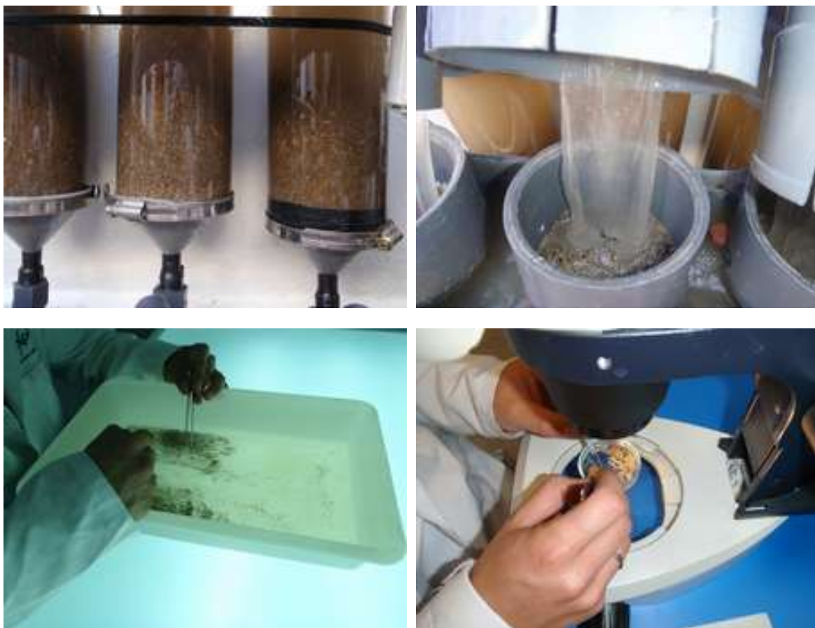
Figura 203. Secuencia de fotografías que describen el funcionamiento del elutriador, separación de los individuos y determinación taxonómica de los mismos.
