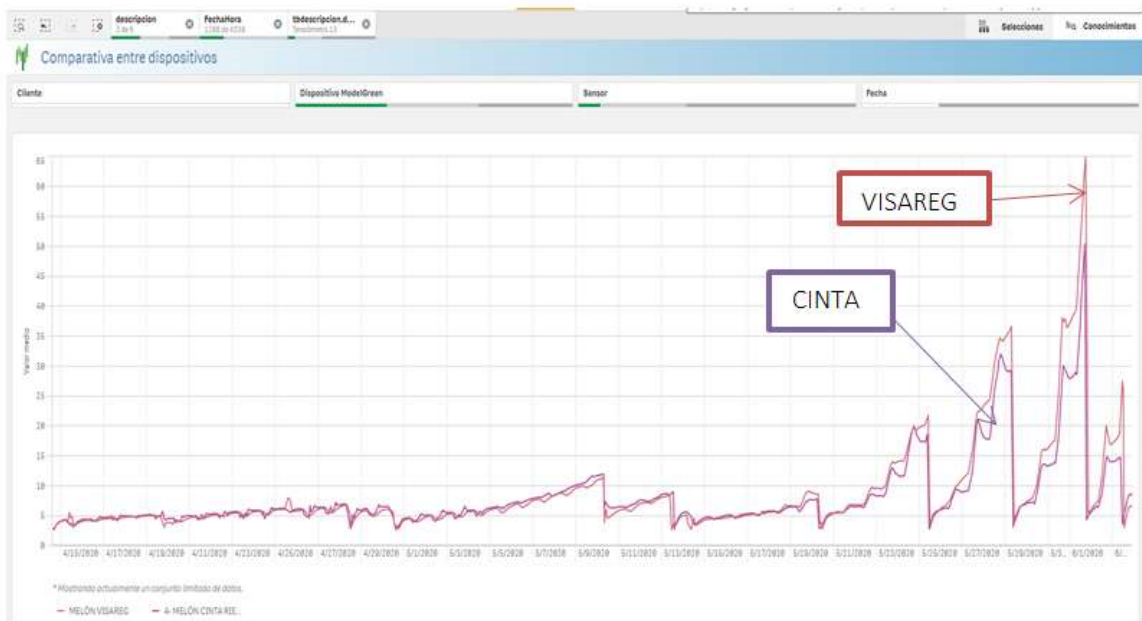
Imagen nº3 Lectura de las sondas Cinta y Visareg a 15 cm de profundidad
