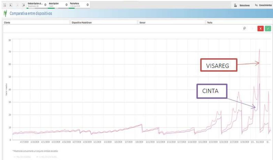
Imagen nº4 Lectura de las sondas Cinta y Visareg a 30 cm de profundidad
