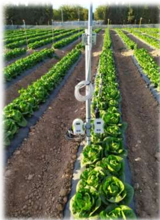
Imagen nº2 Tensiómetros para el control del riego
