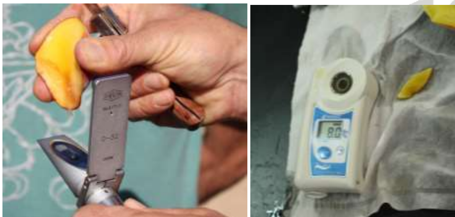
Fotos nº 24 y 25. Medida de los grados Brix con refractómetro en laboratorio una vez recolectada la fruta.
