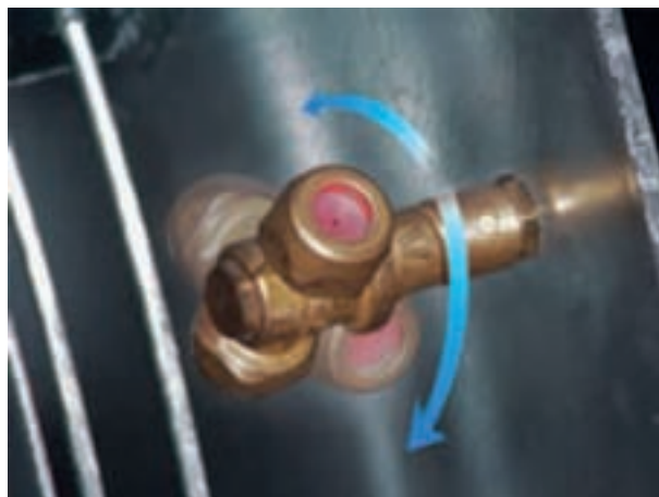
Imagen 13. Jet orientable para cambio de boquilla.
