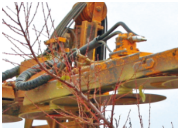
Cuchillas cortando el brazo de un árbol en su parte superior.
