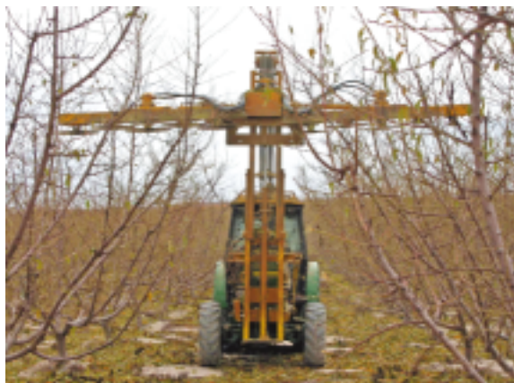
Podadora mecánica de cuchillas.
