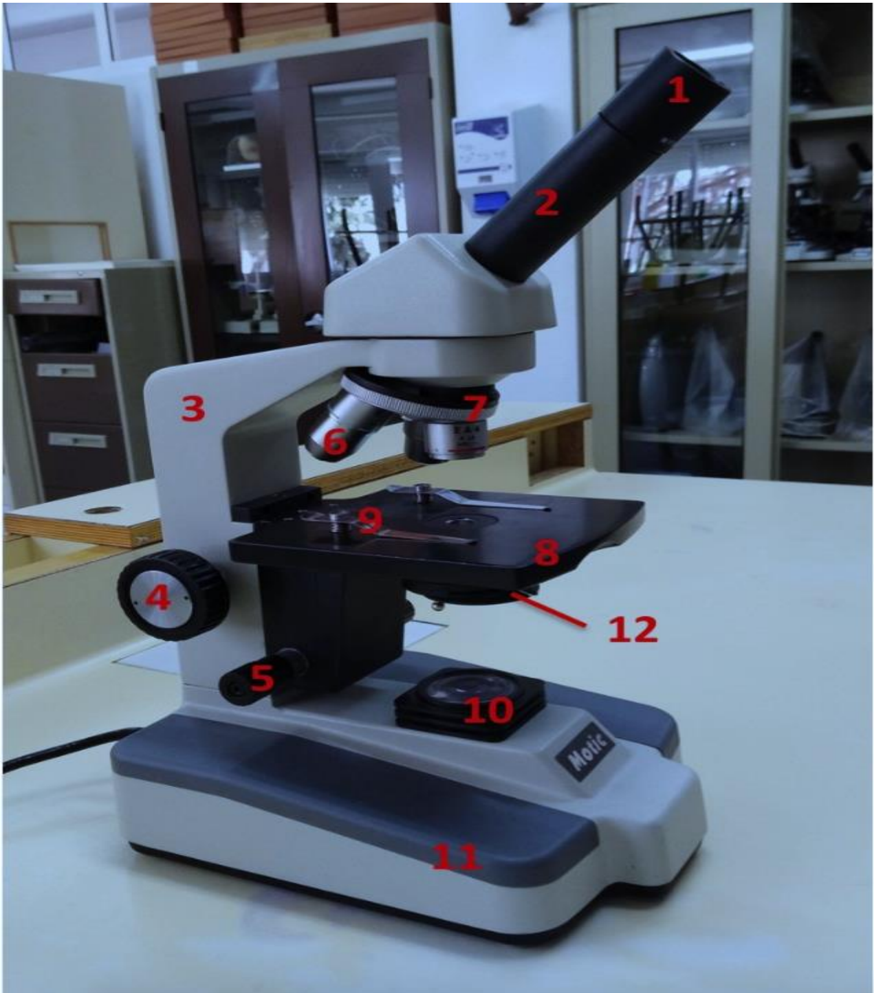
Figura 20. Aspecto general de un microscopio óptico utilizado de rutina en un laboratorio de Educación Secundaria. (1) Ocular, (2) Tubo, (3) Brazo, (4) Macrométrico, (5) Micrométrico, (6) Objetivo, (7) Revolver, (8) Platina, (9) Pinzas sujeta muestras, (10) Fuente de iluminación, (11) Pie y (12) Diafragma.
