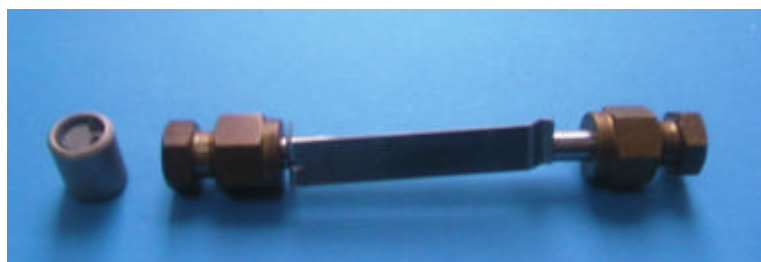
Figura 4.4 Muestreador pasivo ATD50 Tenax TA con cabezales para transporte y cabezal de difusión.
