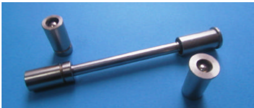
Figura 4.5 Tubo para sistema de desorción térmica ATD50 con cabezales para desorción.
