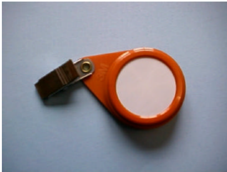
Figura 3.2 Muestreador pasivo 3M-3500.
