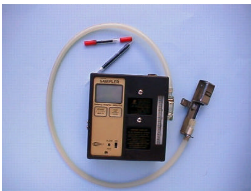
Figura 1.6 Sistema de muestreo dinámico.
