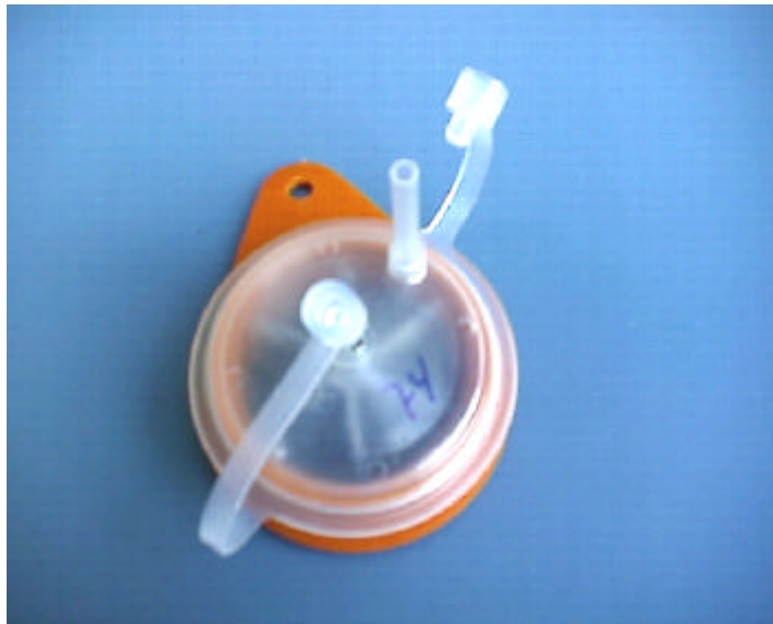
Figura 3.4 Muestreador pasivo 3M-3500 preparado para desorción.
