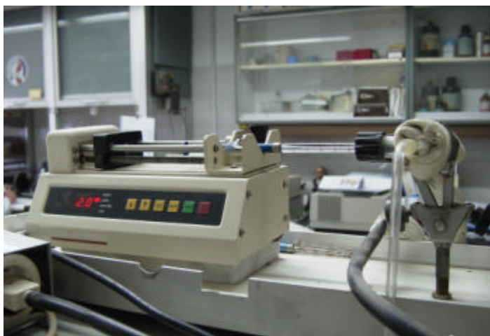
Figura 3.6 Inyector automático de jeringa.
