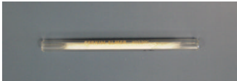
Figura 6.3 Tubo adsorbente empleado como trampa.
