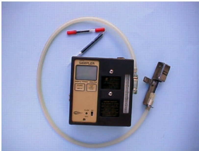
Figura 3.3 Sistema de muestreo dinámico.
