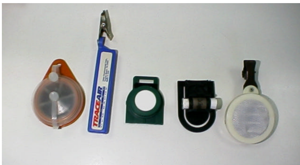
Figura 1.8 Distintos diseños para muestreo pasivo.
