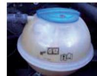
**Líquido lavaparabrisas.** Comprobar nivel y reponer **sin esperar** a que esté vacío el depósito. No emplear **nunca agua del grifo** para rellenar el depósito ya que los sedimentos del agua pueden estropear los conductos del circuito.
