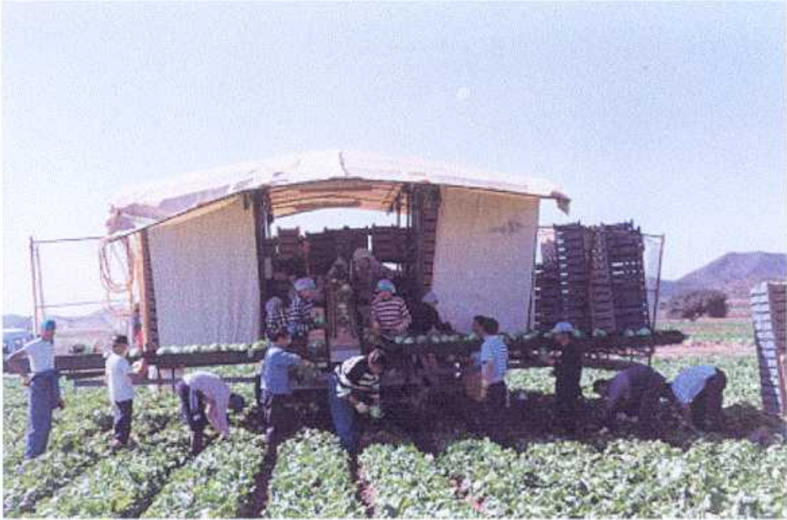
PLATAFORMA AUTOMOTORA SOBRE NEUMÁTICOS CON PERSONAL SUBIDO Y CORTE DELANTERO (VISTA FRONTAL)
