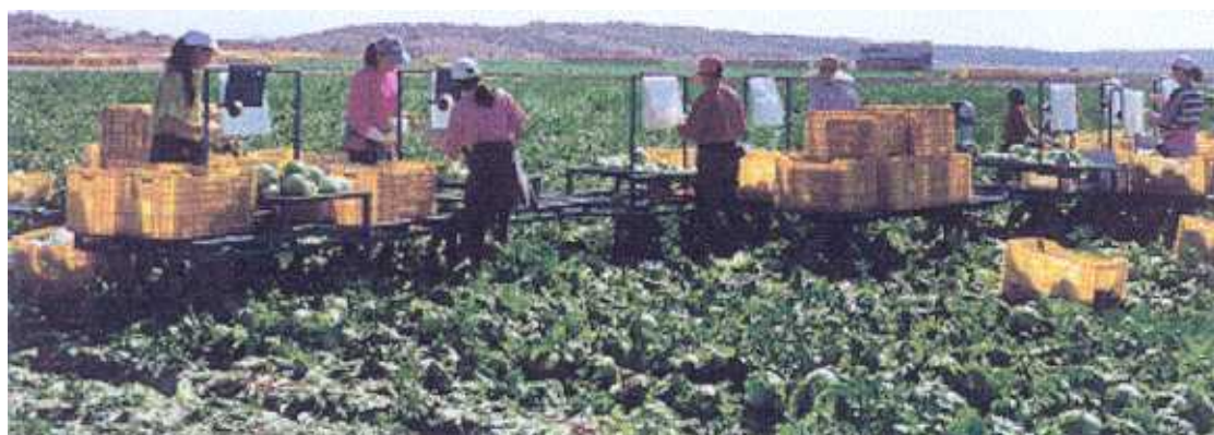
- PLATAFORMA DE EMPUJE MANUAL CON PERSONAL A PIE - CORTE DELANTERO
