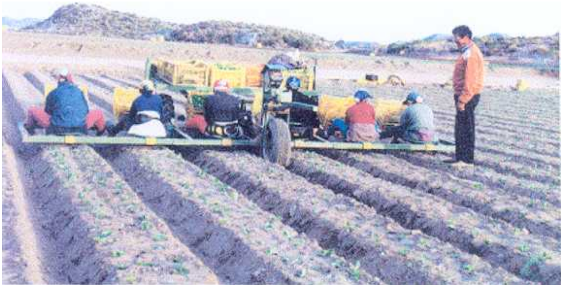
PLATAFORMA PLANTADORA AUTOMOTORA PERSONAL SUBIDO
