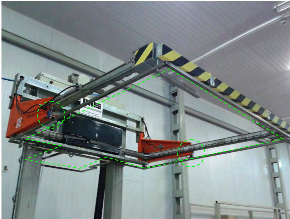
Figura 12. Ejemplo dispositivo de protección contra fuerza ejercida en Flejadora
