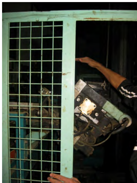
Figura 6. Ejemplo zona de operación accesible en Despaletizador (manipulador)
