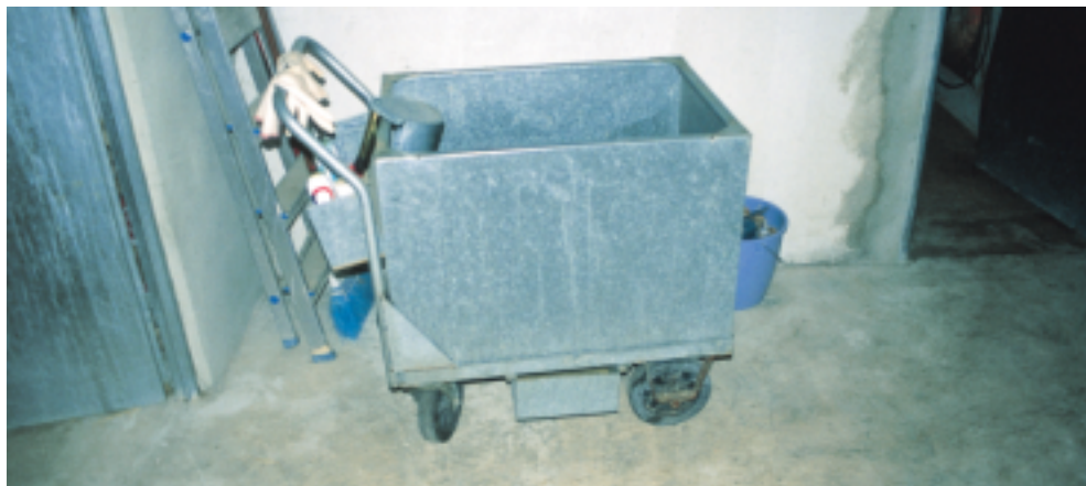
Carrito de distribución de pienso con bandeja posterior para tratamientos.
