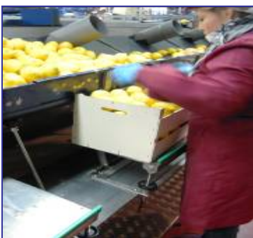
Plataforma adicional que eleva el plano de trabajo y reduce la flexión del cuello.
