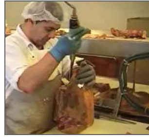
Gubia eléctrica con mango ergonómico para favorecer la postura neutra de la muñeca
