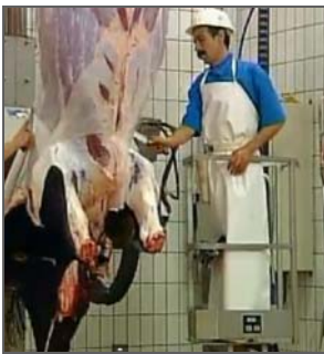
Plataforma de elevación que permite acceder a todas las partes del animal sin posturas forzadas en tronco o brazos
