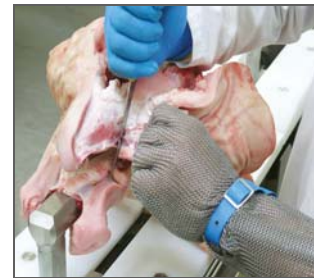
Cepo de sujeción para facilitar el corte evitando movimientos de la pieza sobre la mesa
