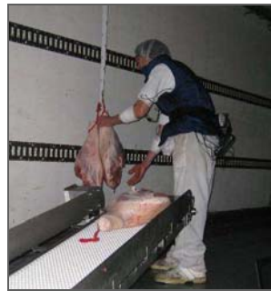
Pechas para jamones con ajuste automático que permiten que siempre se cuelguen a una altura adecuada
