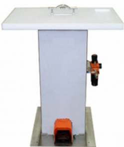
Mesa para deshuese de piezas con altura regulable según pieza a deshuesar
