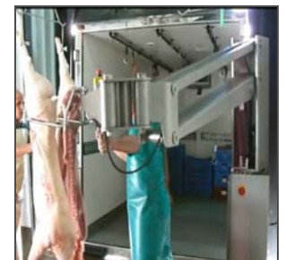
Brazo móvil para cargar camión
